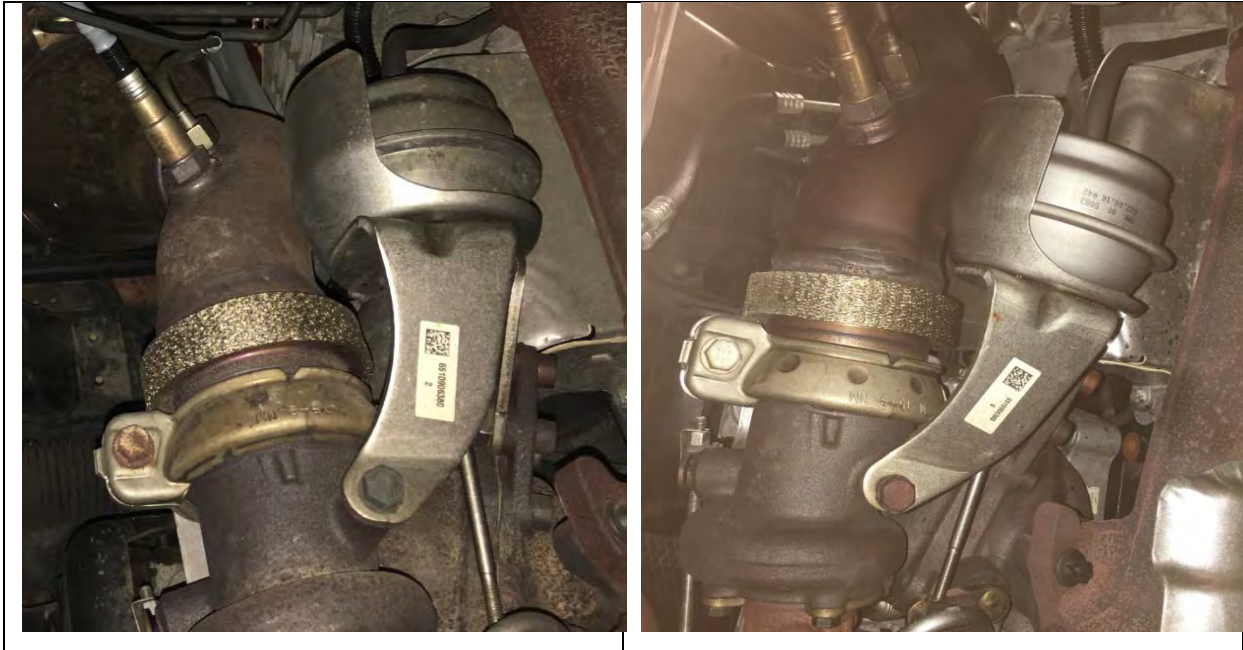
Abbildung 6: Abgasturbolader mitsamt p_4 , T_4 Sensorik von oben betrachtet mit Wastegatesteller über Druckdose.
