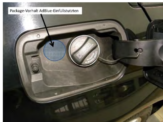
Abbildung 52: Tankdeckel mit geometrischem Vorhalt für den AdBlue-Einfüllstutzen
