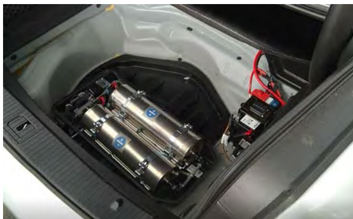
Abbildung 25: ASDS-System Prototyp verbaut in der Reserveradmulde
