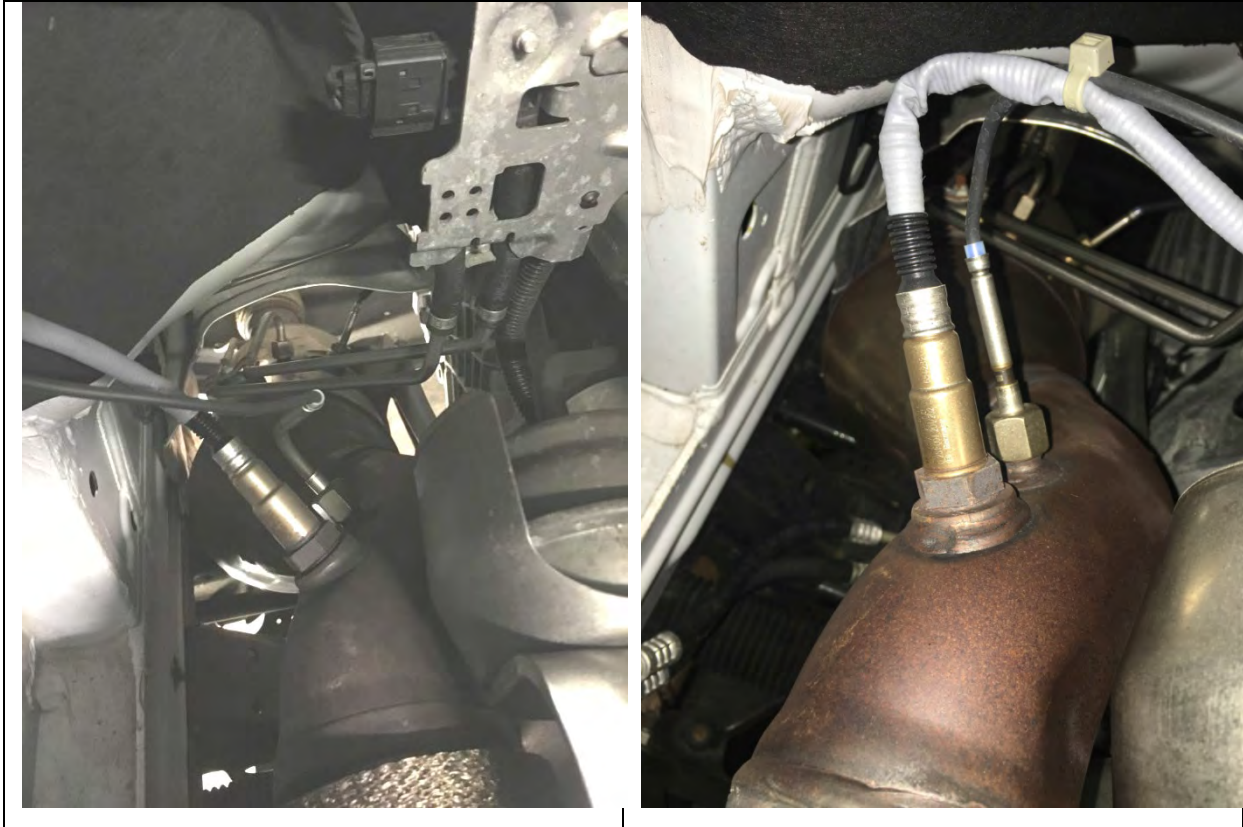
Abbildung 14: Identisch positionierte Aufnahme der Druck- und Temperatursensoren p_4 , T_4
