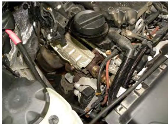
Abbildung 51: Motorraum abgasseitig – Einbausituation von AGR, Turbolader und motornaher DOC/DPF-Einheit
