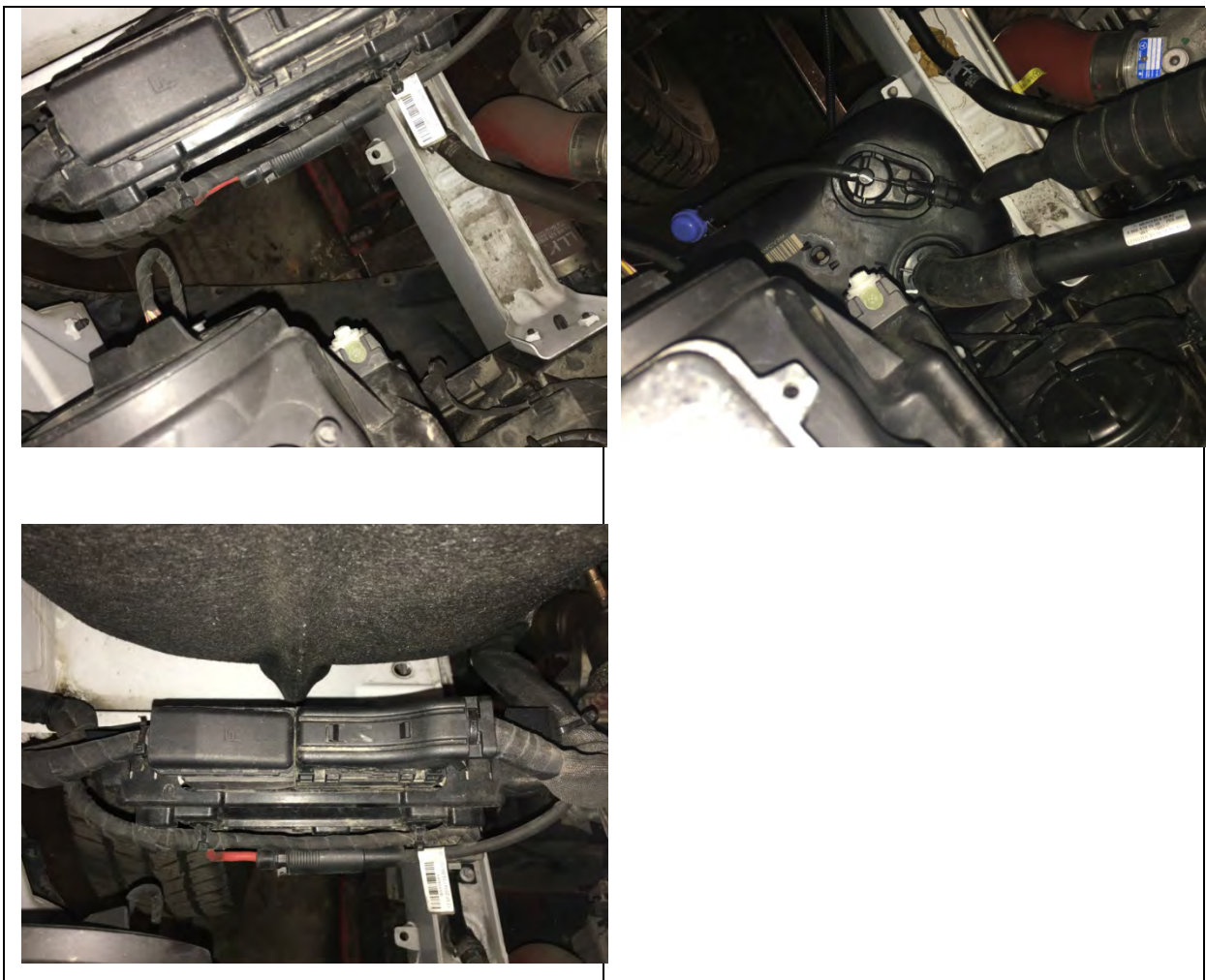
Abbildung 5: Bereich des Motorsteuergeräts beim EURO5 Fahrzeug in Fahrtrichtung rechts unterhalb des Luftansaugkastens für die Innenraumbelüftung
