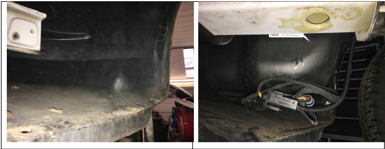
Abbildung 4: Position des Adblue-Tanks nach Abbau der Radlaufverkleidung
