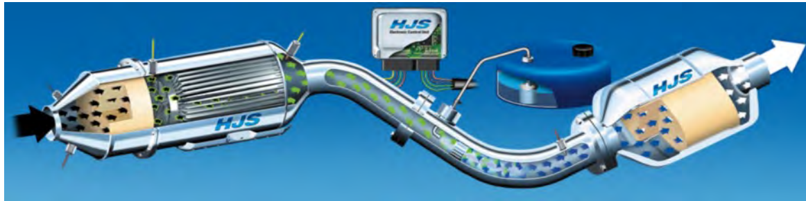
Abbildung 31: SCRT®-System (Quelle HJS)
