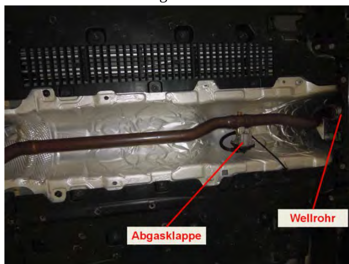
Abbildung 78: Platzverhältnisse im Unterbodenbereich
