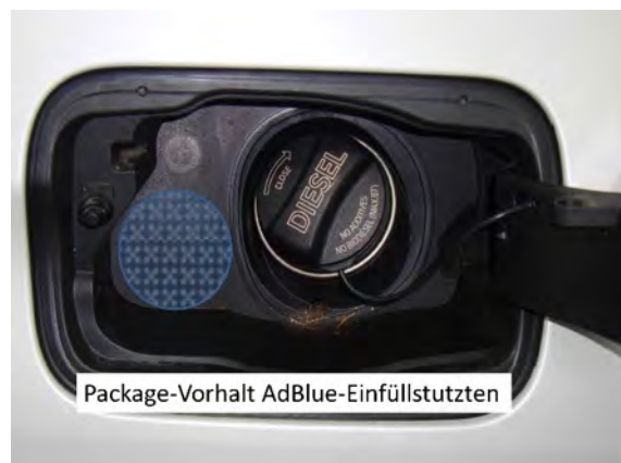
Abbildung 58: Tankdeckel mit geometrischem Vorhalt für den Adblue-Einfüllstutzen
